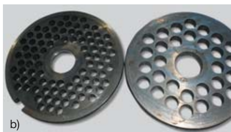
szarpak (rozkrawacz) (a) i tarcze tnące (b) (źródło: zbiory własne)
